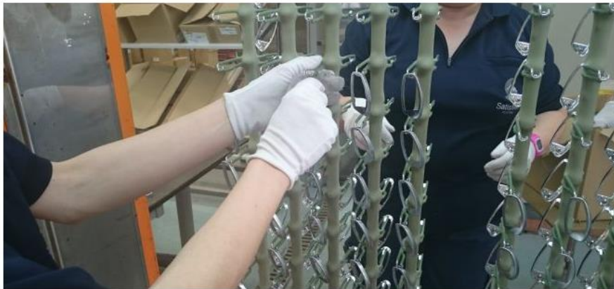
Operarias de Satis-Coating descuelgan las piezas cromadas de los bastidores. La empresa obtuvo ayudas por 127.000 euros para probar una nueva tecnología. (Satis-Coating)
